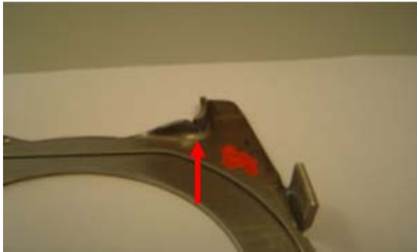
Şekil 14: H4 Histerezis Rondelasını Kulak Bölgesindeki Yırtılmalar.
