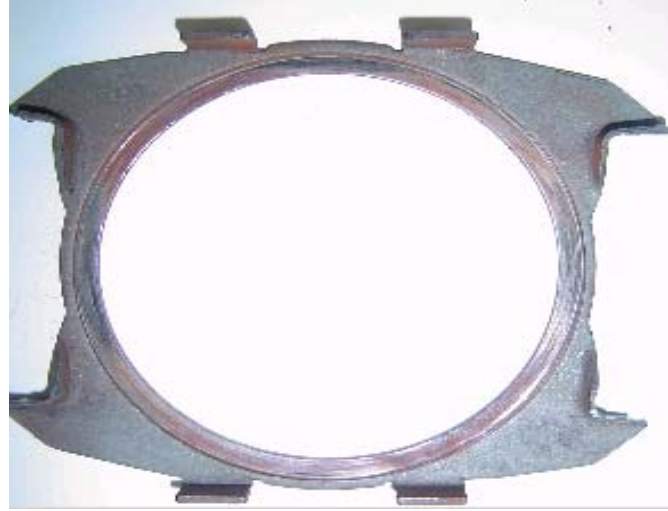
Şekil 7: C15E Malzemesinden üretilmiş H4 Histerezis Rondelasının yorulma deneyi sonrasındaki görünümü (2milyon devir).
