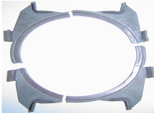
Şekil 6: DD11 Malzemesinden üretilmiş H4 Histerezis Rondelasında yorulma deneyi sonrasında meydana gelen kırılmalar (1 milyon çevrim).
