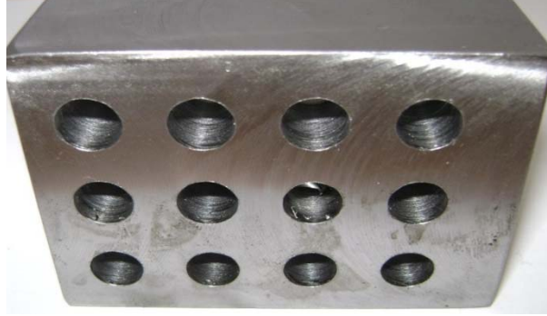
Şekil 3: Kılavuzlar için matkaplarla açılan ön delikler
