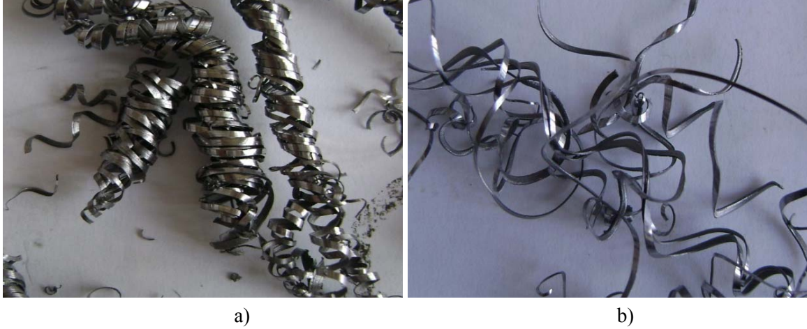
Şekil 10: AISI 1050 malzemesine vida açılmasında kullanılan kılavuz tipine bağlı çıkan talaşlar a) 15^{\circ} uç açılı düz kanallı kılavuzlar, b) 15^{\circ} ve 30^{\circ} Helisel kanallı kılavuzlar
