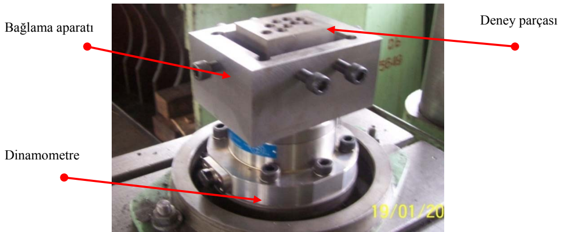
Şekil 2: Üzerine deney parçasının bağlandığı bağlama aparatının dinamometreye bağlanmış durumu
