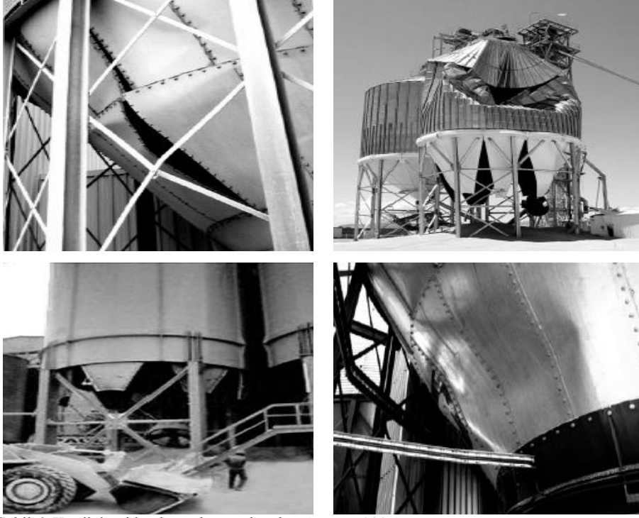
Şekil 6. Konik hunide oluşan kopma hataları (Rotter, 2009).
