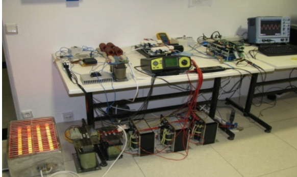
Şekil 13. BGKD deneysel düzeneğin fotoğrafı (UPQC experimental prototype photograph)
