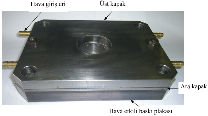
Şekil 7. HEBP' nin üst kapak, ara kapak ve hava giriş bağlantıları ile montajlı durumu (Assembly of air effected blank holder with intermediate plate, top plate and air entrance connections)
