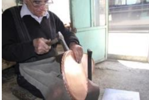
Foto. 38: Çekiç ile tepsi kenarını kıvrırma
