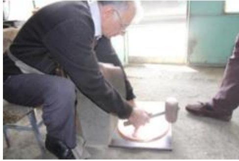
Foto. 37: Tokmak ile düzleştirme
