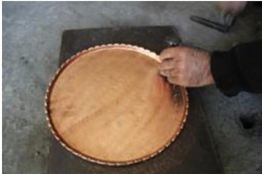
Foto.40: Çekiç yardımıyla zımba ile süsleme
