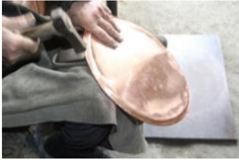
Foto. 36: Çekiç ile tepsi kenarını yuvarlama
