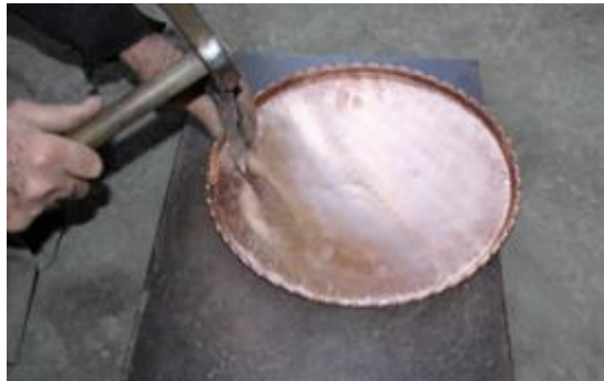
Foto.41: Zımba ile kenarlarını süsleme
