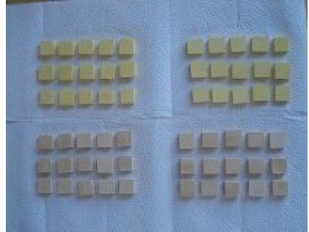
Resim 1. Tip III ve tip IV dental alçı kullanılarak hazırlanan örnekler
