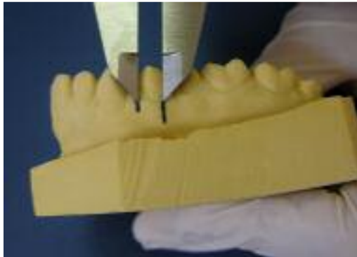
Resim III: Referans çizgileri arası ölçümün yapılması
