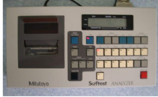
Resim 2: Yüzey pürüzlülüğü ölçüm cihazı ve örneklerin pürüzlülük değerlerinin saptanması
