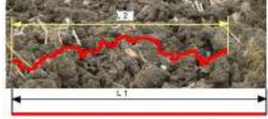
Şekil 4. Toprak yüzey pürüzlülüğünün zincir yöntemiyle belirlenmesi
