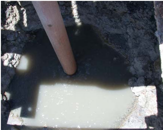
Resim 4. Çamurda karbondiyoksit kabarcıkları. Picture 4. Carbon dioxide bubbles in mud.
