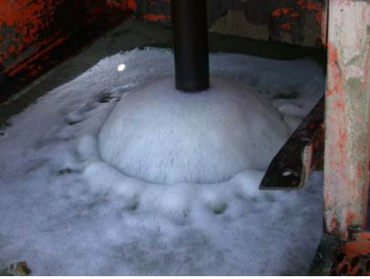
Resim 13. Dolaşım bozukluğuna bağlı karbondioksit çıkışları. Picture 13. Carbon dioxide output based on circulatory disorder.
