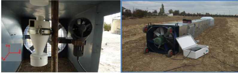
Şekil 3. Rüzgâr erozyon setinin genel görünüşü ve tünel içindeki sediment tutucu ve hızölçer Figure 3. General view of the wind erosion sets and inside the tunnel sediment holder and speed meter
