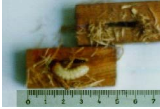
Şekil 5. Larvanın çameks ile emprenyeli odun örneği içinde pupa dönemine geçiş için pupa yastığı hazırlık mücadelesi (Çameks ile muamele edilmiş sarıçam odunları içindeki larvalar odun örneklerinin içini kemirerek tahrip etmişler, larvaların çoğu pupa dönemini geçirmek için emprenyeli odun örneği içerisini tercih etmemiştir.)
