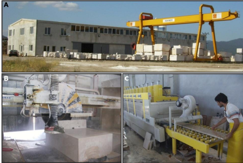
Fotoğraf 2. A- Hüseyin Avni Keleşoğlu Mermer San. Tic. Ltd. Şti.(HAKMER) Mermer Fabrikası'nın dıştan görünümü. B- Fabrikada makineyle mermer kesme işlemi. C- Mermer cilalama işlemi.
