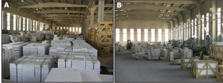
Fotoğraf 1. Mansfield Madencilik ve İnş. San. Tic. Ltd. Şti. Mermer Fabrikası'nda belli ebatlarda kesilmiş ve istiflenmiş mermerler (A) ve palet denilen tahta bloklara yerleştirilmek üzere nakliyyeye hazır hale getirilmiş mermerler (B).
