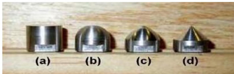
Şekil 10. Darbe testlerinde kullanılan farklı geometriye sahip darbe uçları a) Düz, b) Yarı küresel, c) Ogival, d) Konik (Lim et al., 2002; Tan et al., 2003)
