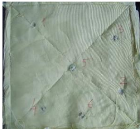
Şekil 3. Aramid Twaron Ct710 kumaşı üzerine yapılan balistik deney (Karahan, 2008)
