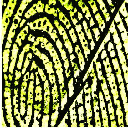
Resim 3: Rodamin 6G İle Floresan Boyama Sonucu Porların Görünüşü
