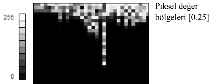
Şekil 6. Hiperspektral bant çiftleri, yani 33 bantın ikili farkları, toplam 32 adet fark görüntüsü (X eksen) ve 25 değere nicemlenmiş renk bölgeleri (Y eksen)
