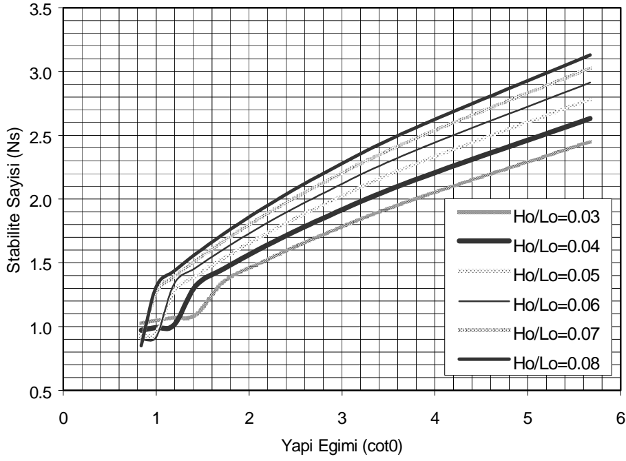
Şekil 5. Denklem (14) ve (15) için dalga dikliklerine göre stabilite sayısının yapı eğimi ile değişimi ( S=2.5 , P=0.38 ve N=2700 )
