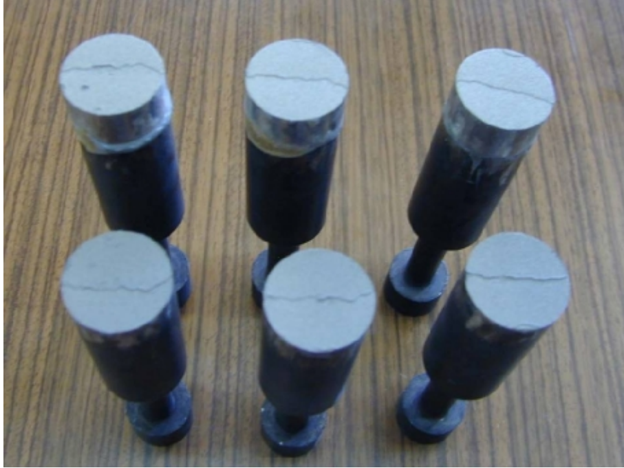
Şekil 12. Çekme deneyinden sonra oluşan kırılma yüzeyleri
