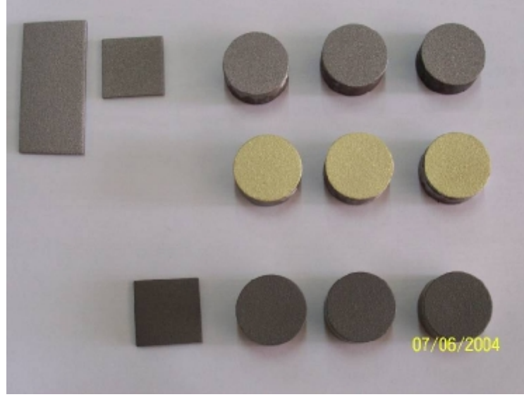
Şekil 3. Farklı tozlarla kaplanmış deney numuneleri
