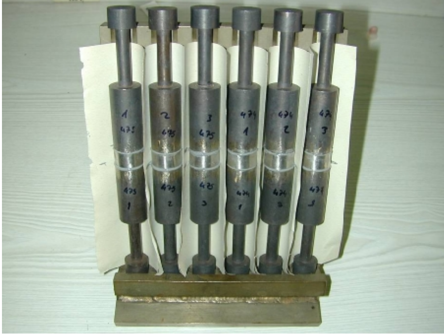
Şekil 4. Çekme numunelerinin deneyden önceki görünümü
