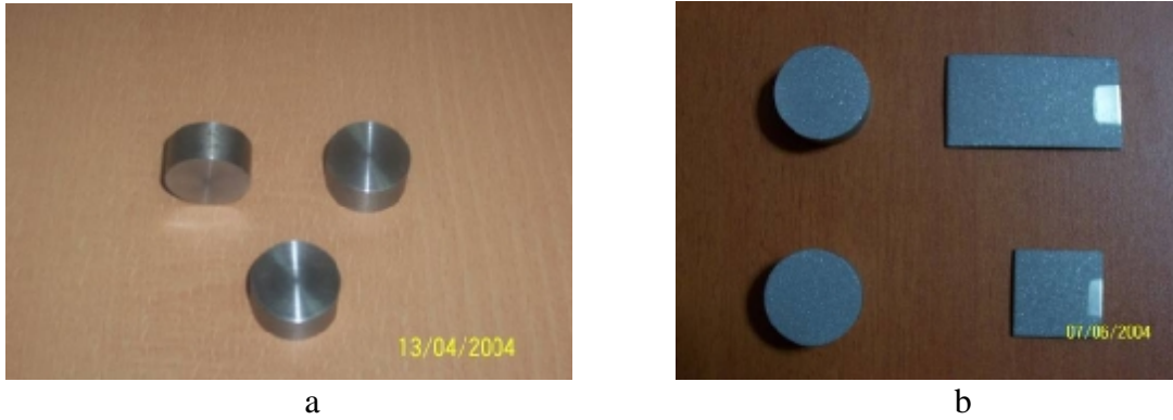
Şekil 2. Plazma sprey sistemi ve kaplama işlemi deney numuneleri a) kumlanmamış, b) kumlanmış
