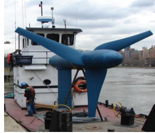
Şekil 2. Verdant Power'a ait yatay eksenli 5 m çapa, 3 kanata ve 35 kW güce sahip akıntı türbini [2]
