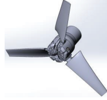
Şekil 12. Göbek ve kanatların birleştirilmiş hali Pozisyon-1 (tam açık)
