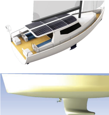
Şekil 4. REPSAIL'in perspektif görünüşü ve türbin yerleşimi
