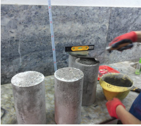
Şekil 7. Silindir numunelere başlık yapılması
