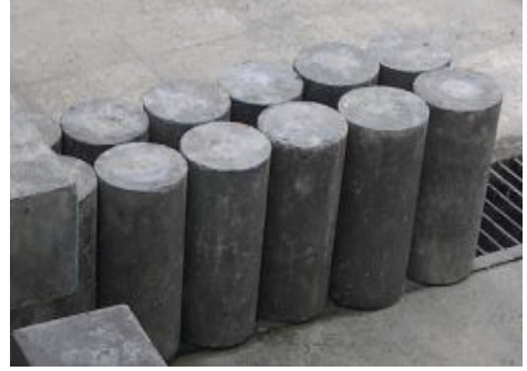
Şekil 2. Beton silindir numuneler
