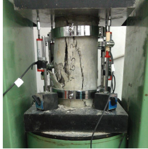
Şekil 10. Basınç deneyi sonrası görünüm
