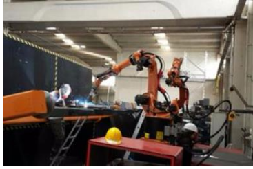
Şekil 2. Sacların soğuk metal transfer kaynağı işlemi.
