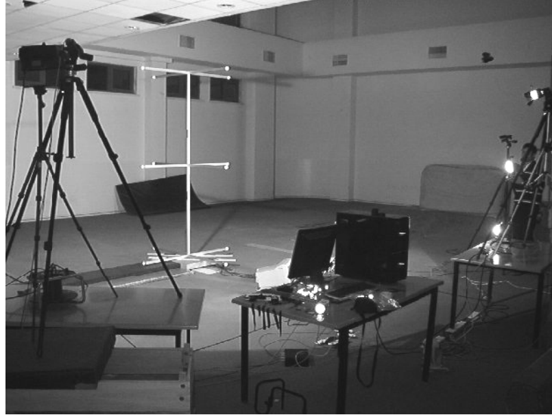
Resim 1. Deneğin uzun atlama görüntüsünün kaydedildiği alanda kameraların, kalibrasyon kafesinin ve hareket analiz sisteminin yerleşimi.
