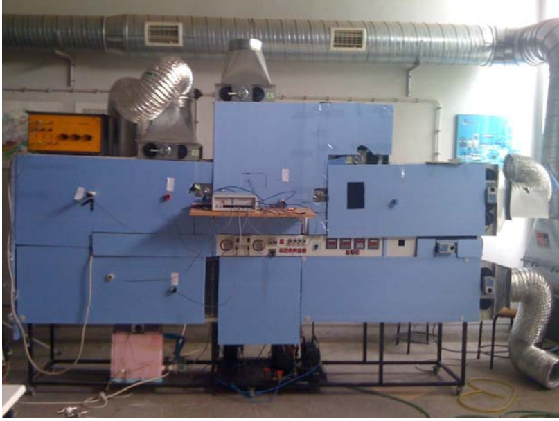
Şekil 1: Isı pompası destekli kurutma ünitesi deney ünitesi
