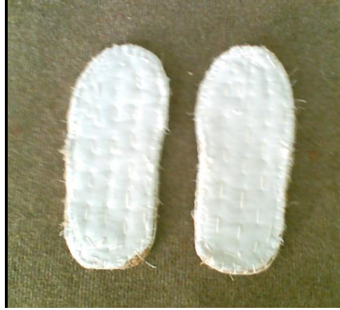
Foto. 20. Taban kalıbının bezlendirilmesi.
