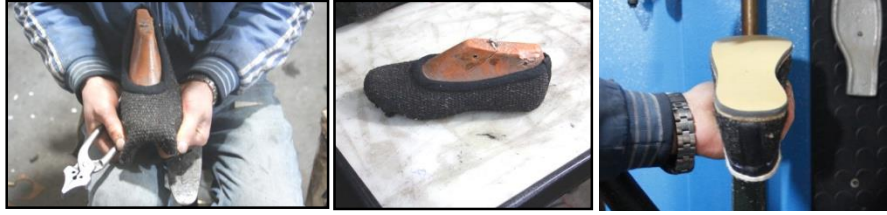
Foto. 9-10-11 Kalıba yerleştirme ve tabanın oluşturulması.
