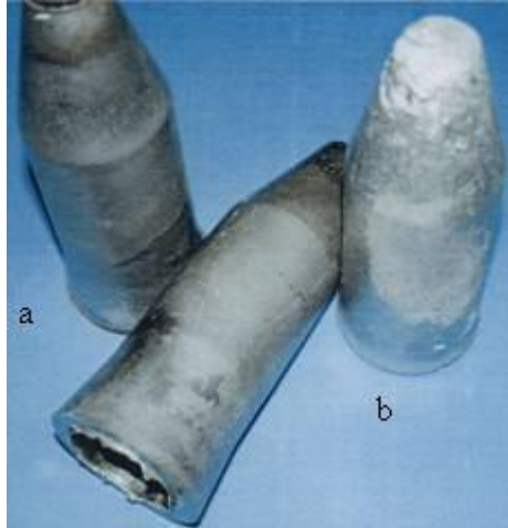
Şekil 2. Sıkıştırılmalı döküm yöntemi ile üretilmiş bomba gövdesi prototipleri, basınç görmüş (a) ve görmemiş (b) halde
