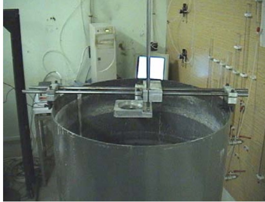
Şekil 3. Silindir model deney tankı üzerine yerleştirilen El Vane Askı sistemi
