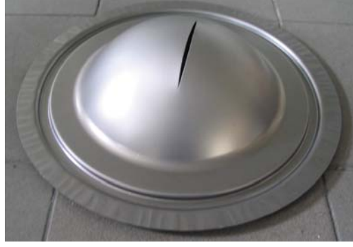
Şekil 2. Kubbe formunda şişirilip tepe noktasına yakın bir bölgeden yırtılmış deney parçası [5]
