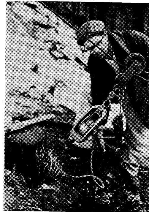
Abb. 3. Das Zugseil gibt als Probeseil genauere Ergebnisse, verursacht jedoch grösseren Zeitaufwand für die Messungen. Zum Niederziehen verwendet man Hanfseilflaschenzug oder Ratschenzug-Handwinde. Zur Messung tritt das 500 kg-Dynamometer an die Stelle von Federwaagen (Aufn. : P.) .
