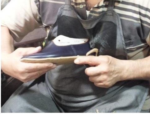
Resim:17- Kenar temizliğinin yapılması
