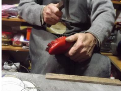
Resim:10- Sayanın kalıba gerilmiş hali
