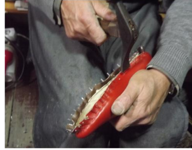
Resim:10- Sayanın kalıba gerilmiş hali
