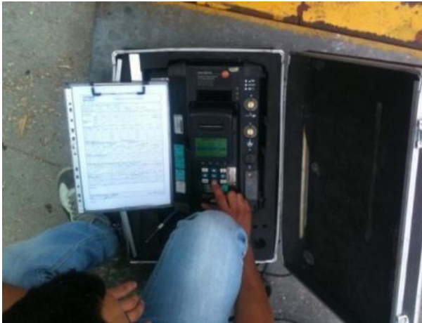
Şekil 2. Baca gazı ölçüm cihazı kalibrasyonu
