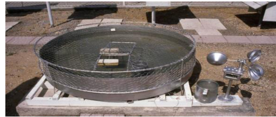
Şekil 1. Class A Pan Buharlaşma Kabı
