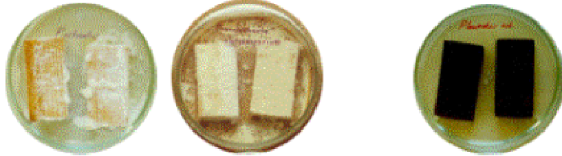
Şekil 3. Üç ay sonra kontrol örnekleri üzerindeki misel gelişimi. sağdaki petri kabında CCA ile emprenyeli odunlarda misel gelişmemesi.
