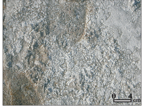
Şekil 19- Kuruma etkisinde gelişen breşik yapı içerisindeki blödit kristalleri
