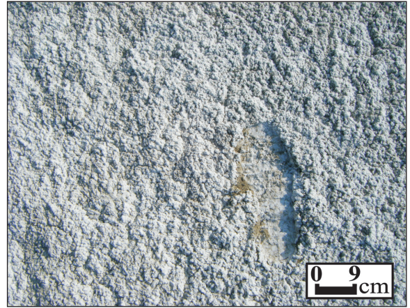
Şekil 10- Jips+Kalsit+blödit zonunu temsil eden pürüzlü zayıf mineralleşme yüzeyi
