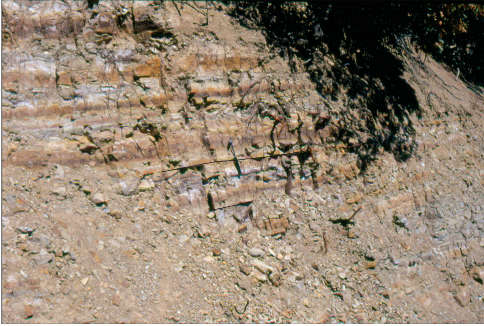
Şekil 10 -Kapıkaya formasyonunun kumtaşı-şeyl ardalanmasından bir görüntü; yer Kayadibi Yayla, Kapıkaya formasyonunun alt düzeyleri. Kumtaşı tabakaları keskin taban ilişkili, killi tabakalar fosillidir (01 FU-04 no.lu örnek).
