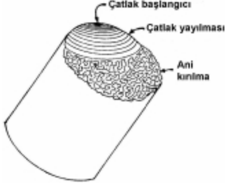
Şekil 1: Çatlağın başlangıç, yayılma ve ani kırılma bölgelerini gösteren çelik bir mildeki yorulma kırığı yüzeyinin resmi [2]
