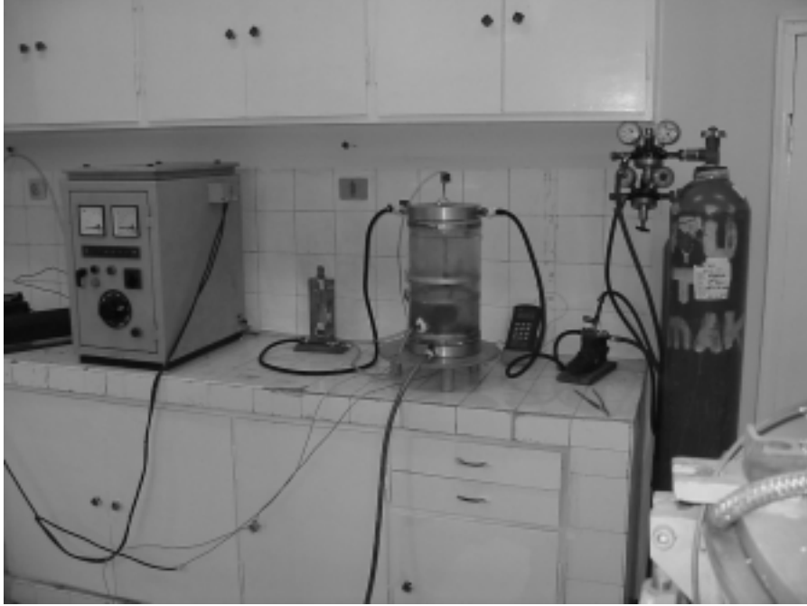
Şekil 1. Plazma nitrüleme tesisi
