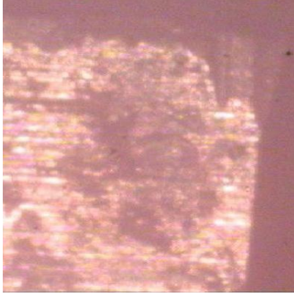
Şekil 2. 23 nolu plakette 1 nci talaş kaldırma deneyi sonrası serbest yüzey aşınması (x100)
