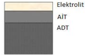
Şekil 1. Anot destekli KOYP hücresini meydana getiren bileşenler.
