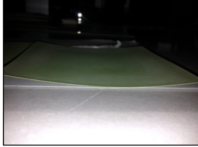
Şekil 4. Birlikte sinterleme işlemi sonrası oluşturulmuş 100 cm 2 alana sahip anot destekli elektrolit.
