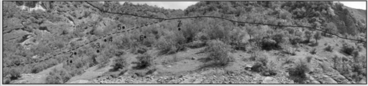
Şekil 9: Kaklık Tepe GB'sında R_1 profili boyunca radon gazı ölçümü yapılan noktalarının genel görünümü.
