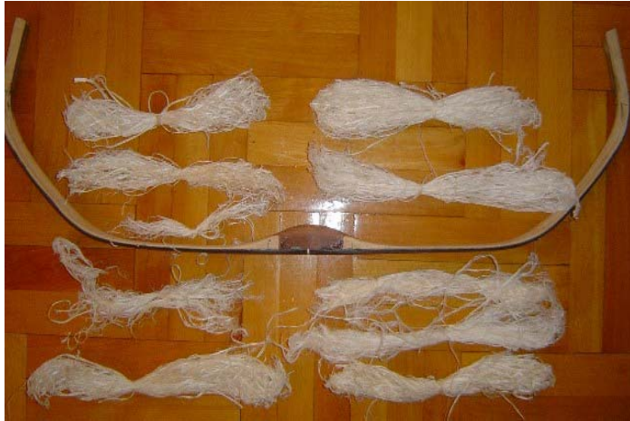
Resim 4. Kullanılacak sinir (tendon) miktarı tartılarak belirlenir ve yayın sırtına döşenir (Yay ve fotoğraf: S. Cem Dönmez).
