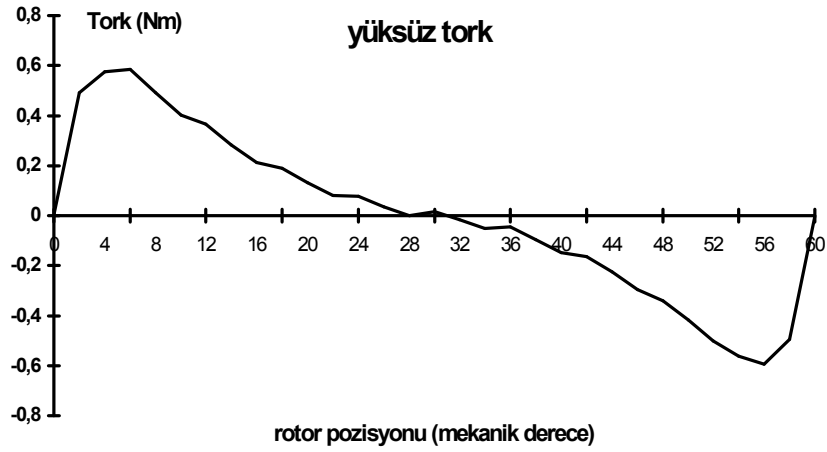
Şekil 7. Maxwell Stress Tensor yöntemi ile yüksüz durumda elde edilen tork
