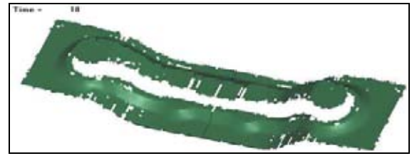
Şekil 10. Pot çemberinin sacı fazla sıkıştırma durumu 4. saniye ve 10. saniye (analiz sonu)
