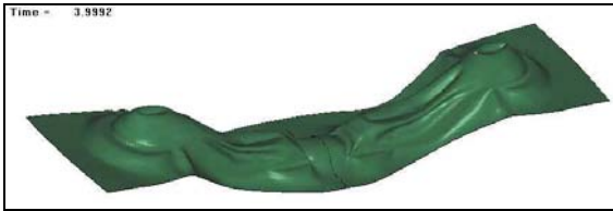
Şekil 11. Sacın kalıp içerisinde buruşması 4. saniye
