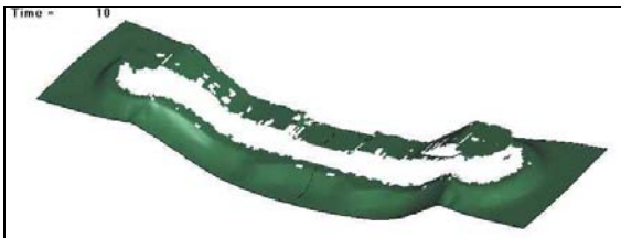
Şekil 12. Buruşmuş sacın şekillendirilmesi analiz sonu
