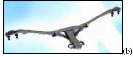
Şekil 1. a) "Tofaş Palio" b) "Fiat Doblo" için hazırlanan çeki kanca sistemi (www.towsure.co.uk, 2004)
