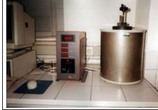
Resim 1. ToniCAL kalorimetresi hidratasyon ölçüm aleti
