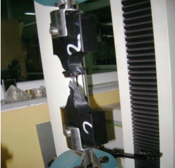
(c) Çekme işlem sonrası görünüm.
