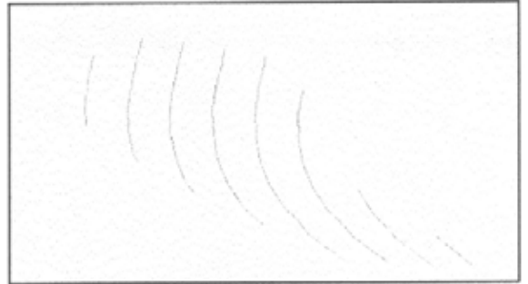
Şekil 16. AutoCAD R 11 programına çizdirilen profil görünüş çizdirilen pulluk şablon eğrileri
