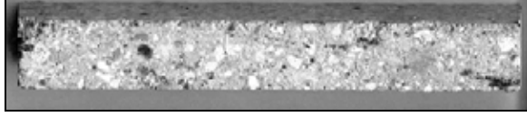
Şekil 7. % 45 Alümina içeren örneğin 1000 (°C)'de 5 ısı çevriminden sonraki görüntüsü (Ölçek : 1 x 1)
