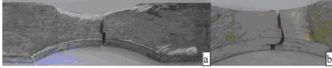
Şekil 6 a) Esas malzeme, b) sürtünme karıştırma kaynağı numunesinin kopma bölgeleri
