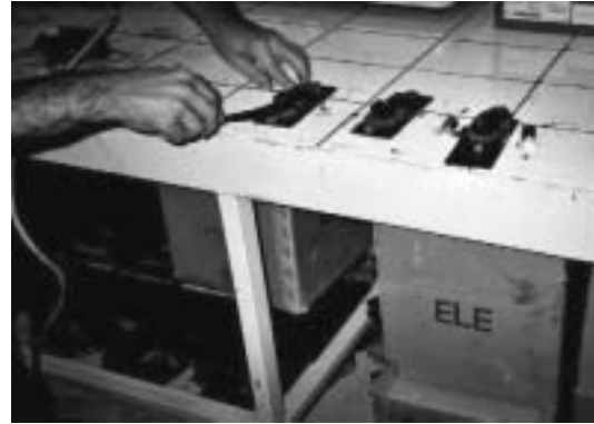
Şekil 4. İçerisine asfalt çimentosu konmuş olan kalıpların görünümü.
